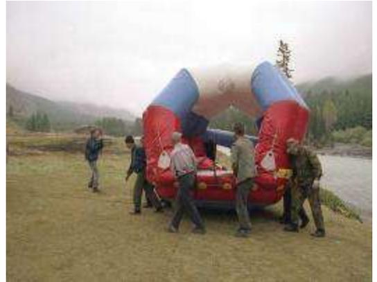
фото № 46 Плот разобрали на два модуля, весом каждый почти 200 кг
